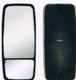
Ford Cargo Cab. Antiga M-026L - Espelho Avulso LD/LE Convexo/Bifocal D-720T - Vidro de Espelho Maior LD/LE D-720U - Vidro de Espelho Menor LD/LE
